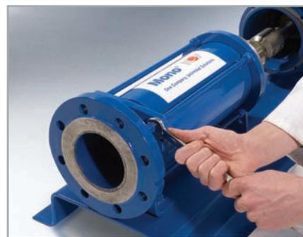
4. Выньте ротор и статор из корпуса насоса
